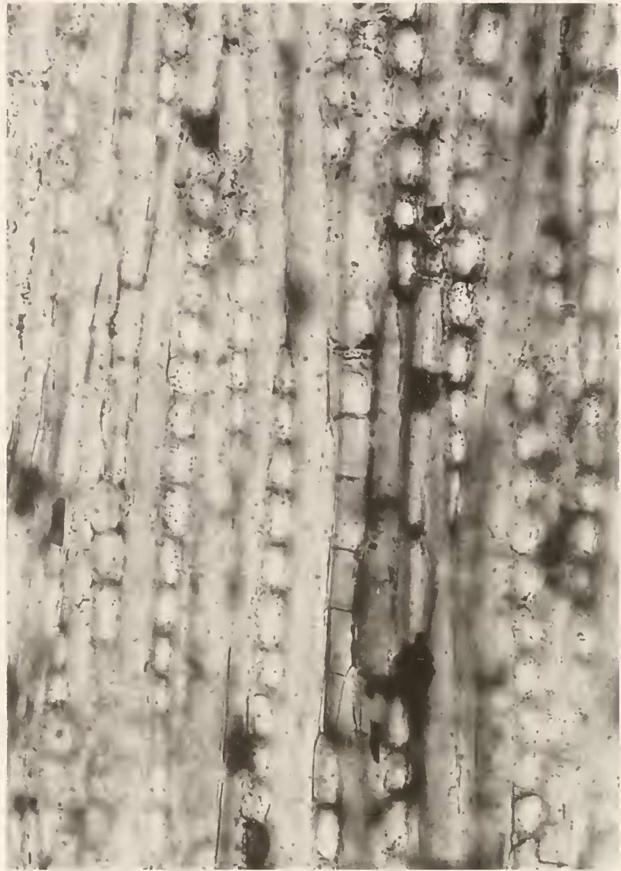
Abb. 9. Tangentialschliff (BSP 1973 I 200). Einreihige, homozellulare Holzstrahlen, dazwischen einige axial verlaufende Parenchymzellen. x 300.
